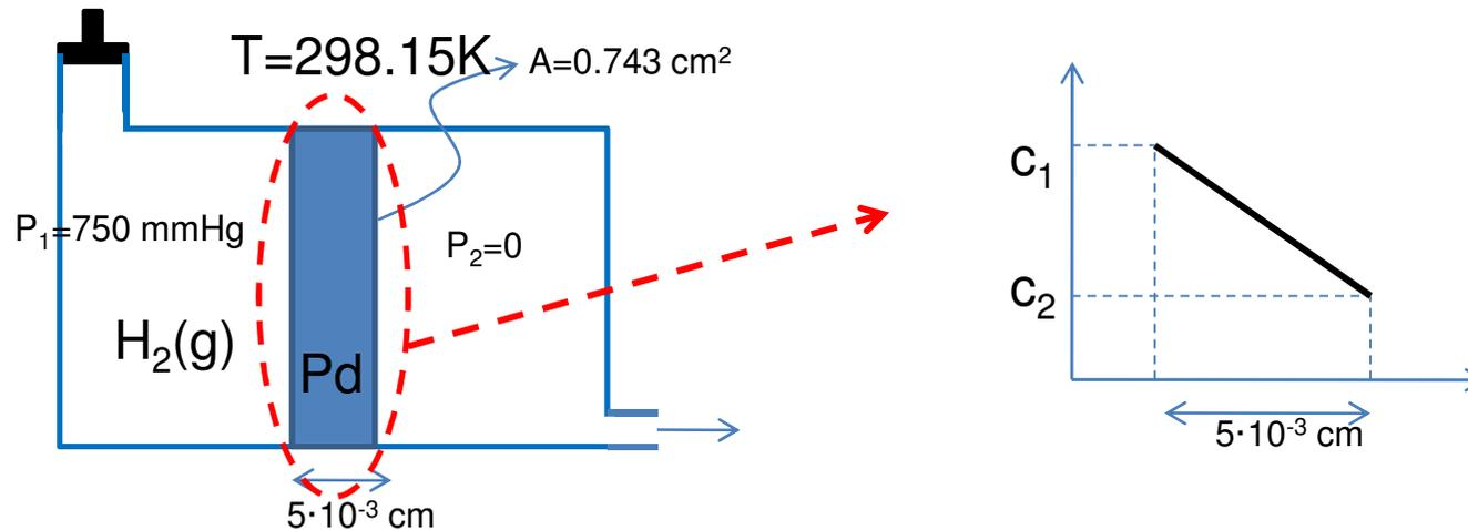
Si mantenemos las presiones de hidrógeno constantes a cada lado de la lámina entonces se alcanzará un estado estacionario con un perfil lineal de concentraciones en la lámina de Paladio
