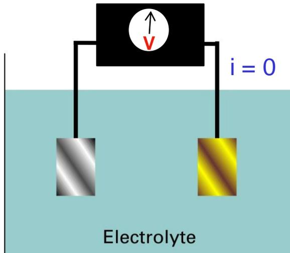
El trabajo que realiza la pila por unidad de carga se gasta en parte en la resistencia interna
