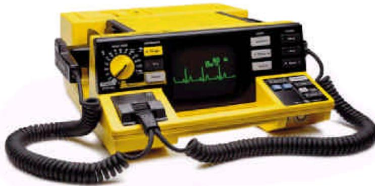
**Figura 3-8. Desfibrilador portátil HP CodeMaster 100.**
