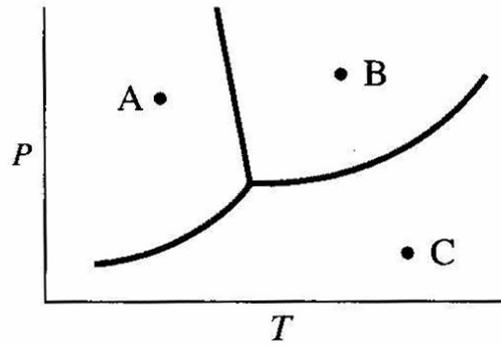
6.12. A continuación se muestra una parte del diagrama de fases del fósforo.
