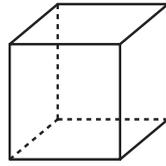
Figura 18. Dibujo de un cubo en proyección paralela.
