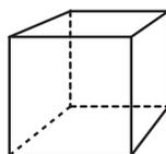
Figura 17. Dibujo de un cubo en perspectiva.
