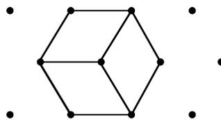
Figura 19. Dibujo de un cubo en proyección isométrica.
