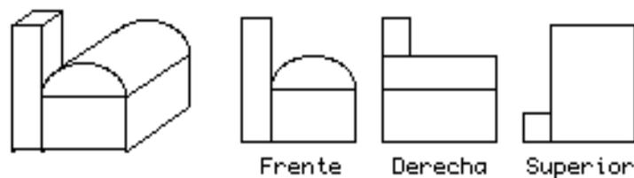
Figura 20. Dibujo de las proyecciones ortogonales de un edificio.
