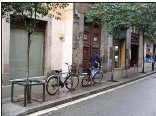
Figura 48: Soportes de tipo U-Invertida en aceras estrechas (BACC)
