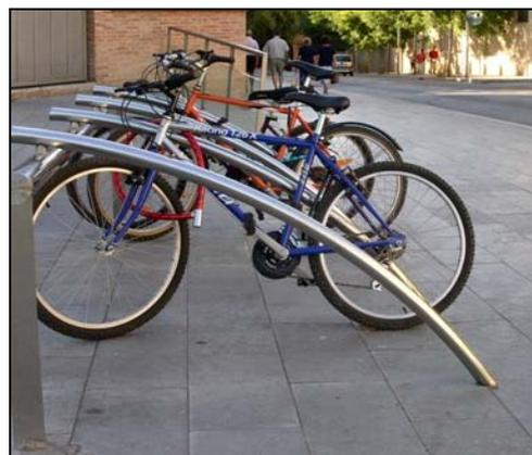
Figura 10: Soportes de tipo semi-circular
