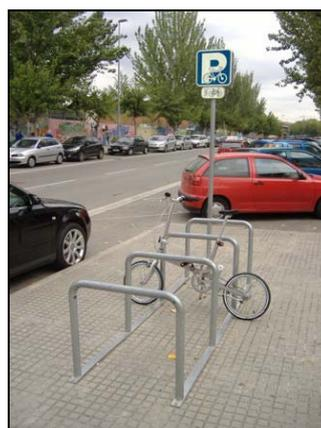
Figura 3: Aparcabicis con soportes de tipo U-Invertida (BACC)
