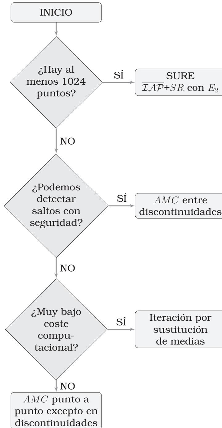
**Figura 5.18:** Indicaciones para la elección de un método de eliminación de ruido.
