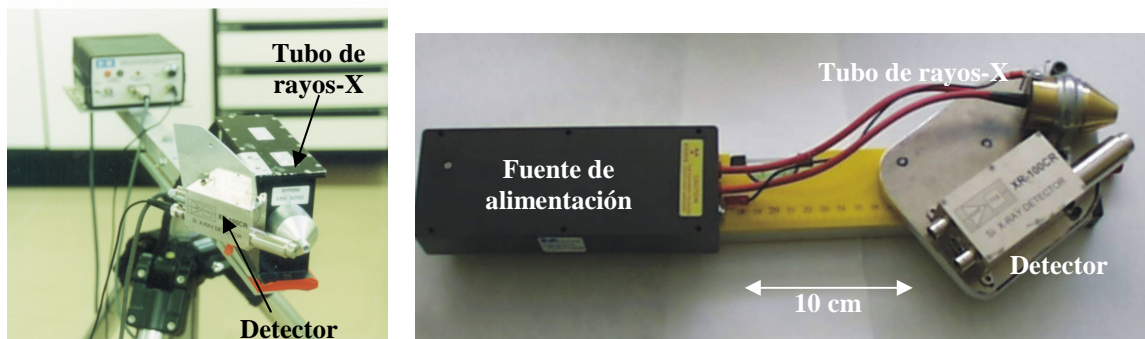
Figura 2: a) Espectrómetro EDXRF portátil con detector Si-PIN y tubo de rayos-X EIS XRG35 (izquierda). b) Espectrómetro EDXRF portátil con detector Si-PIN y tubo de rayos-X MOXTEK (derecha).
