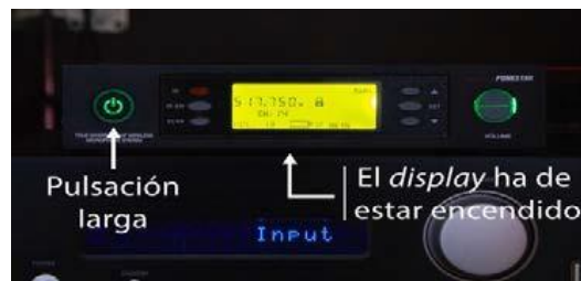
Detall del receptor del micròfon, amb indicació del botó d'encesa i el display
