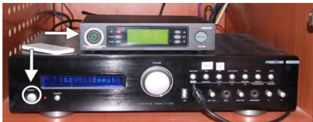
Receptor del micròfon (equip superior) i amplificador (equip inferior) amb els respectius botons d'encesa
