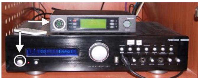
Receptor del micròfon (equip superior) i amplificador (equip inferior) amb els display respectius botons d'encesa
