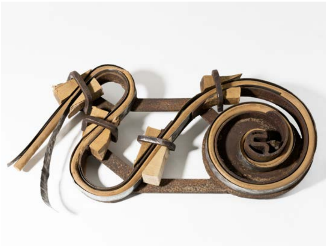
FIG. 1. Motlle metàl·lic per a fer l'espiral d'un balancí. Espal corbat (Fundació Caixa Vinaròs).
