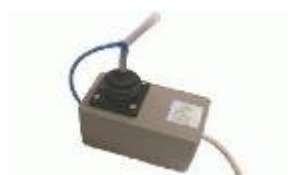
Emulador de ratón con joystick para boca
