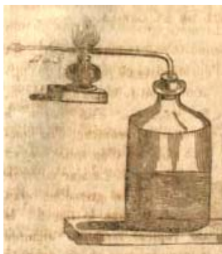
Aparato diseñado por Marsh según la versión modificada que empleaba Orfila alrededor de 1840. Procedente de la obra de A. Chevallier, J. Barse, Manuel pratique de l'appareil de Marsh ou Guide de l'expert toxicologiste... Paris: Labé, 1843. Si se compara con la versión original de Marsh se podrá comprobar que existen notables diferencias. Por ejemplo, esta versión permitía trabajar con mayores cantidades de muestra.
