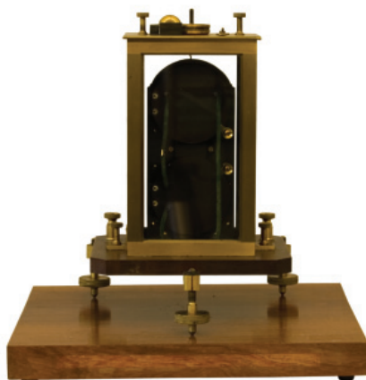
Galvanômetro diferencial, Nalder Bros & Thompson, Londres, adquirido em 1922. (Foto: acervo FEUPmuseu)
