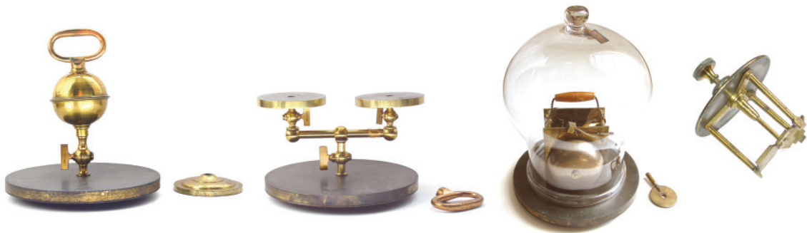
Alguns dos instrumentos da coleção Clarke: hemisférios de Magdeburgo, dupla platina, campainha com mecanismo de relojoaria e campânula, e dispositivo para queda simultânea de três graves. (Fotos: acervo MC/UP)
