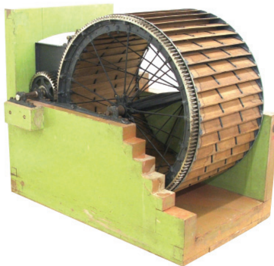
Roda Hidráulica vertical, recebendo água por um dos lados com escoamento e corredeira (núcleo de hidráulica). (Foto: acervo MISE/UP)
