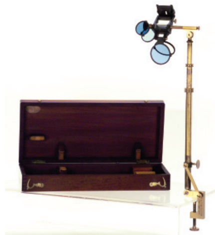
Câmara lúcida de Amici, L'Ing. Chevallier, 1840. (Foto: acervo GF/UC)
