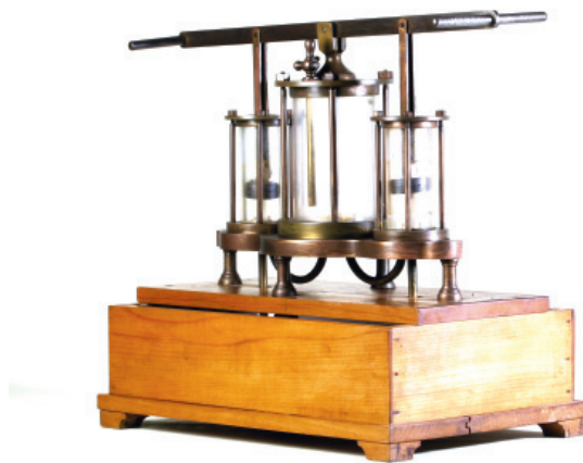
Bomba de incêndios, Les Fils d'Émile Deyrolle, Paris, seg. met. séc. XIX - primeira déc. séc. XX. (Foto: acervo MFISEL)
