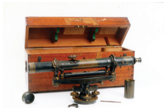
Nível topográfico (ON), T. Cooke & Sons Ltda, York, séc. XIX (final). (Foto: acervo MAST)
