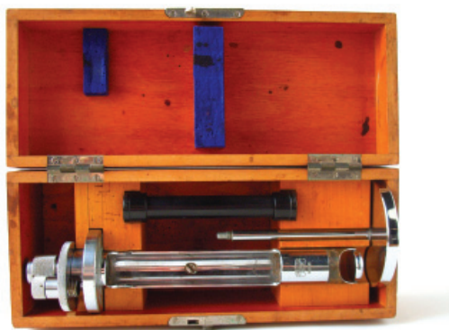
Micropolarímetro, Carl Zeiss, Jena. (Foto: V. Teixeira, acervo MCUL)
