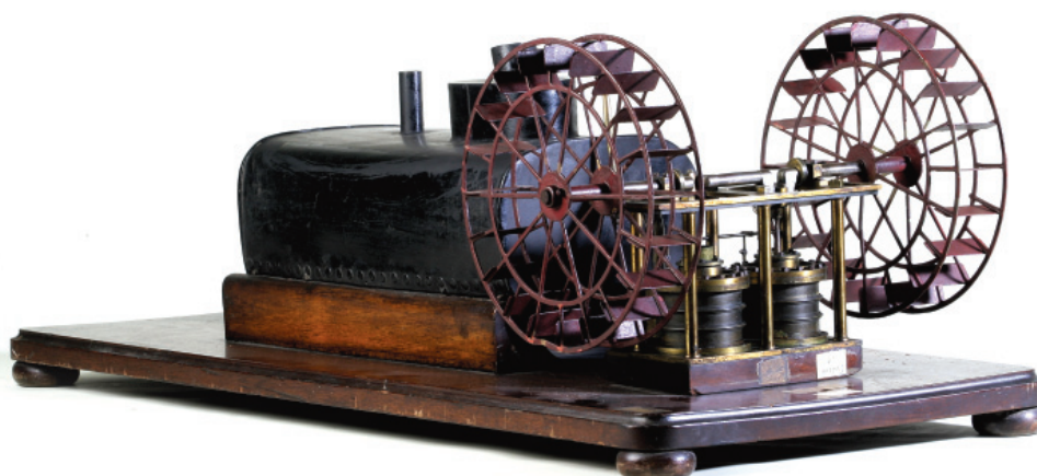
Máquina a vapor marítima de dois cilindros, fab. desconh., seg. met. séc. XIX - prim. déc. séc. XX. (Foto: acervo MFISEL)
