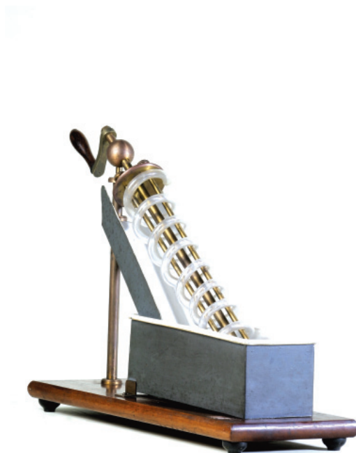
Parafuso de Arquimedes, Les Fils d'Émile Deyrolle, Paris, seg. met. séc. XIX - primeira déc. séc. XX. (Foto: acervo MFISEL)
