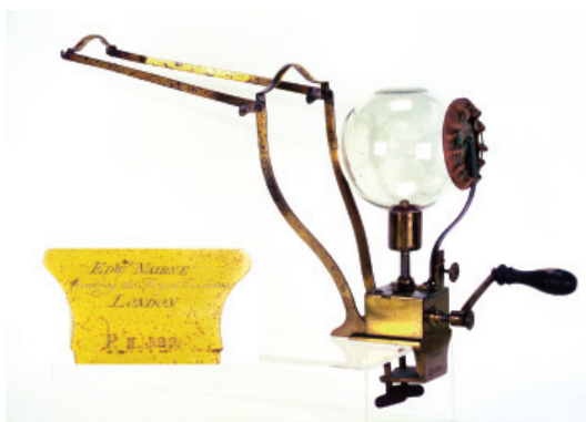
Máquina eletrostática, E. Nairne. (Foto: acervo GF/UC)
