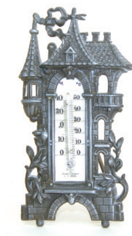
Termômetro com escalas Réaumur e Celsius de temperatura. (Foto: acervo MF/UFJF)
