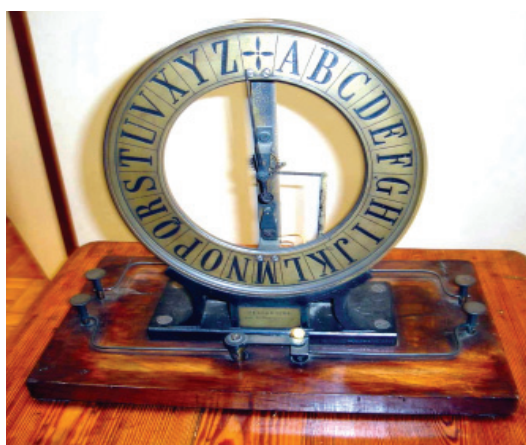
Modelo de telégrafo de agulha - receptor. (Foto: acervo MEP/UFRJ)
