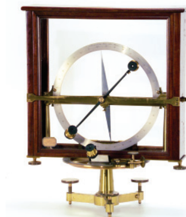
Bússola de inclinação, J. Salleron, 1863. (Foto: acervo GF/UC)
