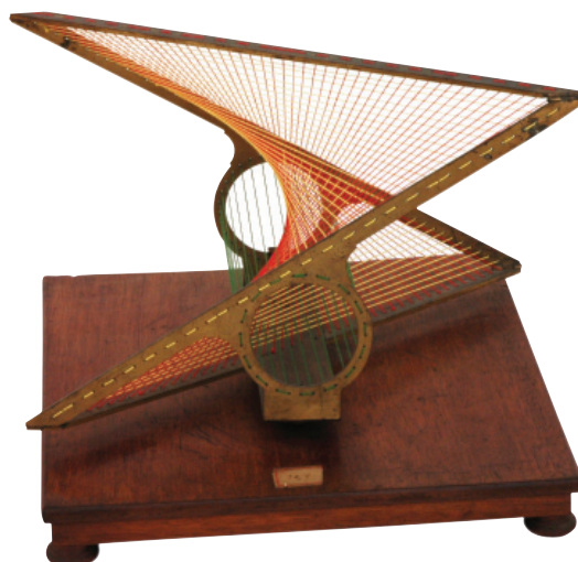
Modelo de Geometria Descritiva, intersecção de cilindro com um parabolóide hiperbólico. (núcleo de Matemática). (Foto: acervo MISE/UP)
