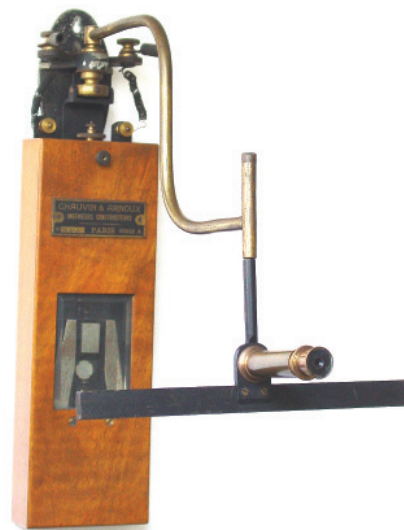
Galvanômetro de quadro móvel, Chauvin & Arnoux, Paris, início do séc. XX . (Foto: acervo MC/UP)
