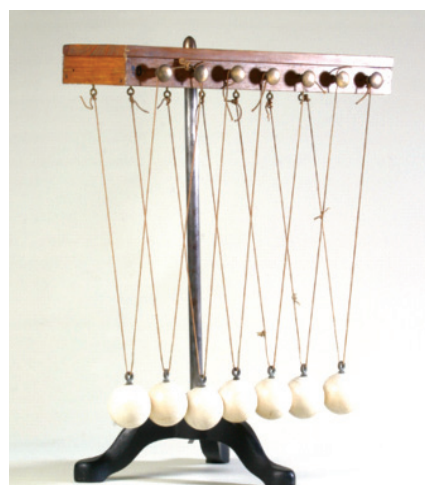
Aparelho para estudo de choques elásticos, seg. met. séc. XIX ou primeira déc. séc. XX. (Foto: acervo MFISEL)
