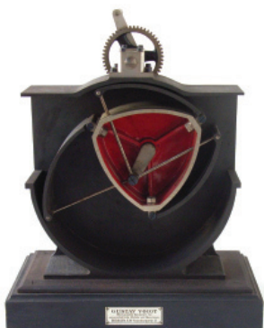
Modelo de ventilador de Lemielle segundo Reuleaux, fabricado por Gustav Voigt, Berlim. (Foto: V. Teixeira, acervo MCUL)
