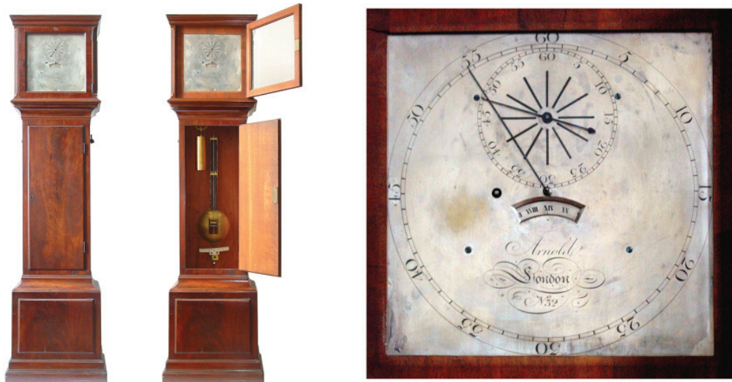
Pêndula astronômica compensada, J.R. Arnold, 1798. (Foto: acervo MC/UP)
