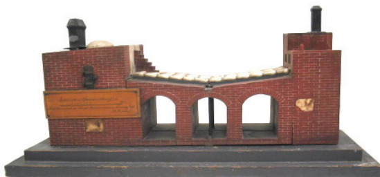
Modelo em escala de forno de cuba para mercúrio, método espanhol (núcleo de Minas e Metalurgia). (Foto: acervo MISE/UP)
