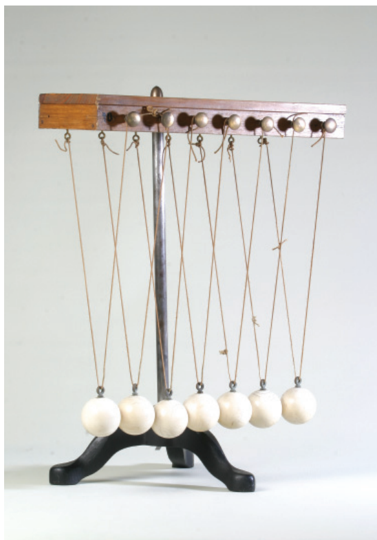
Aparelho para estudo dos choques elásticos, fab. desconhecido, seg. met. séc. XIX - primeira déc. séc. XX. (Foto: acervo MFISEL)
