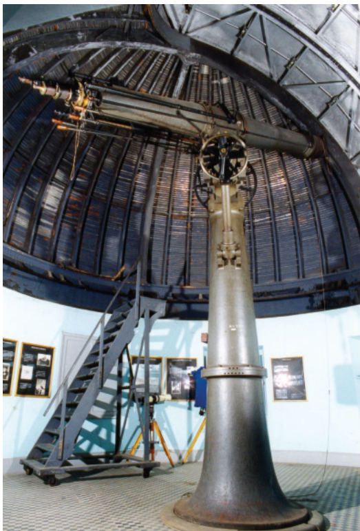
Luneta equatorial de 32cm (ON), T. Cooke & Sons York, séc. XIX (final). (Foto: acervo MAST)
