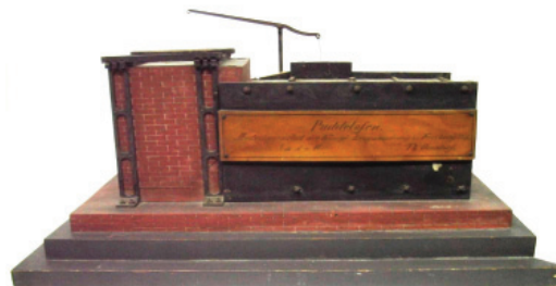
Modelo à escala de forno de revérbero para pudlagem, (núcleo de Minas e Metalurgia). (Foto: acervo MISE/UP)
