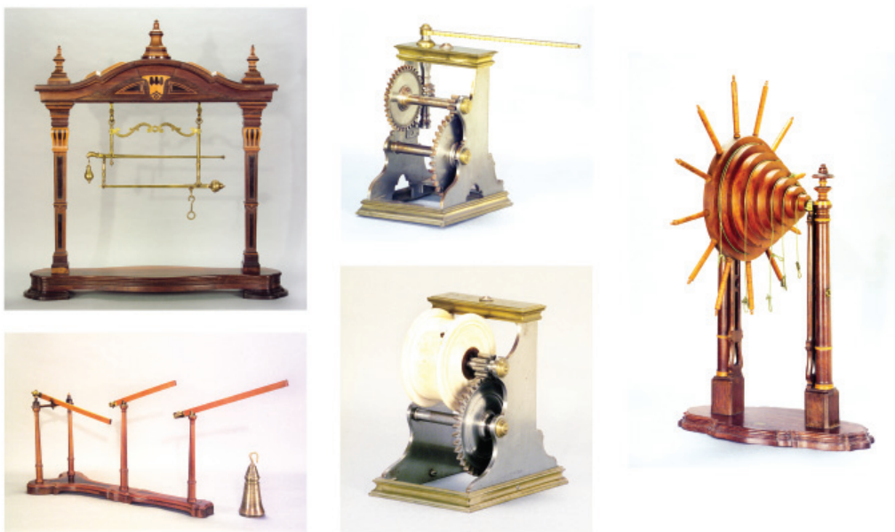
Instrumentos do Gabinete de Física executados a partir da tabela XI de 's Gravesande: balança romana composta, alavanca tripla, modelo de sarilho e duas máquinas compostas. (Foto: acervo GF/UC)
