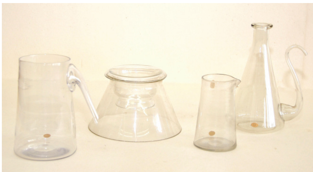
Frascos de vidro diversos (de Pisani, de diálise, de erlenmeyer e florentino) . (Foto: acervo MF/UFJF)
