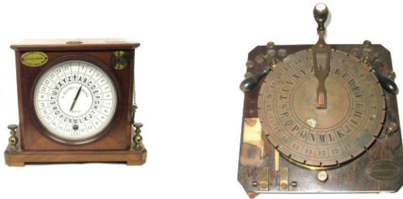
Telegrafo Sistema Bréguet, receptor e manipulador. Louis-Clement Breguet (1804-1883), (núcleo de Eletrotécnica). (Foto: acervo MISE/UP)
