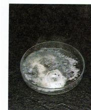
FIGURA 18.2 Cuando se añade agua al hidruro de calcio, se oxida el ion hidruro a hidrógeno molecular, que forma las burbujas que vemos en la fotografía.
