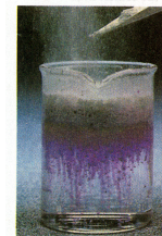
FIGURA 22.6 La reacción del \text{CaH}_2 con agua es vigorosa y exotérmica. El color púrpura rojizo se debe a la fenolftaleína adicionada al agua, la cual indica la formación de iones \text{OH}^- . El burbujeo es causado por la formación de \text{H}_2 gaseoso.
