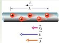
Hilo conductor por el que circulan cargas debido a la existencia de un campo eléctrico
