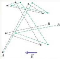
Sin campo eléctrico las cargas se mueven aleatoriamente (líneas grises de la figura) con velocidades  $\approx 10^6 \text{ m/s}$ . Con campo eléctrico los electrones se mueven con una velocidad media denominada velocidad de arrastre  $-v_d$ , siendo  $|v_d| \approx 10^{-5} - 10^{-4} \text{ m/s}$  (líneas verdes de la figura).
