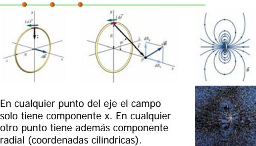
En cualquier punto del eje el campo solo tiene componente x. En cualquier otro punto tiene además componente radial (coordenadas cilíndricas).
