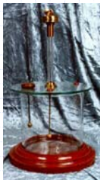
Balanza original utilizada por Coulomb
