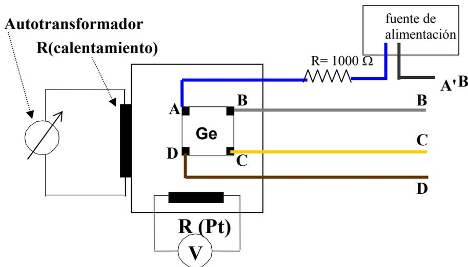
Puesto que el hilo azul (A) está conectado a la fuente de alimentación, es el hilo que sale de ésta (A') el que ha de usarse siempre para medidas de corriente, junto con cualquier otro que se quiera considerar (amperímetro en serie). Es decir, independientemente de la configuración de hilos que se elija para medidas de tensión y corriente por el método de van der Pauw, **EL HILO QUE SALE DE LA FUENTE (A') SIEMPRE DEBE ESTAR CONECTADO AL POLÍMETRO QUE MIDE CORRIENTE.**
