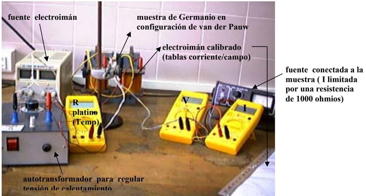
La muestra cuadrada de **Germanio** (de **0.5 mm** de grosor) está montada en un sistema de calentamiento formado por una resistencia de soldador, un portamuestras y una resistencia de platino embutida en el portamuestras como sensor de temperatura. Del sistema salen ocho hilos: dos de la resistencia de calentamiento (negros), dos de la resistencia de platino (negro y rojo), a conectar en un polímetro) y cuatro de la muestra (**A: azul; B: gris; C: amarillo y D: marrón**):
