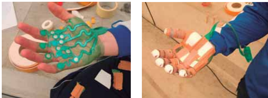
Figura 30. Guante instrumentado para la medición de presiones palmares (Biofoot/IBV): Sin protección (izquierda) y con protección tradicional (derecha).
