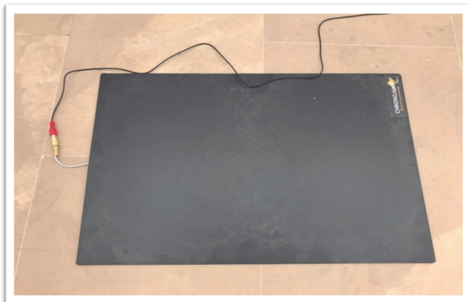
Figura 2- Plataforma de contacte chronojump ®
