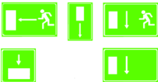
Vía/salida de socorro
