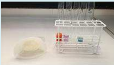
Filtro con la caseína separada y tubos de ensayo con los resultados del análisis cualitativo.
