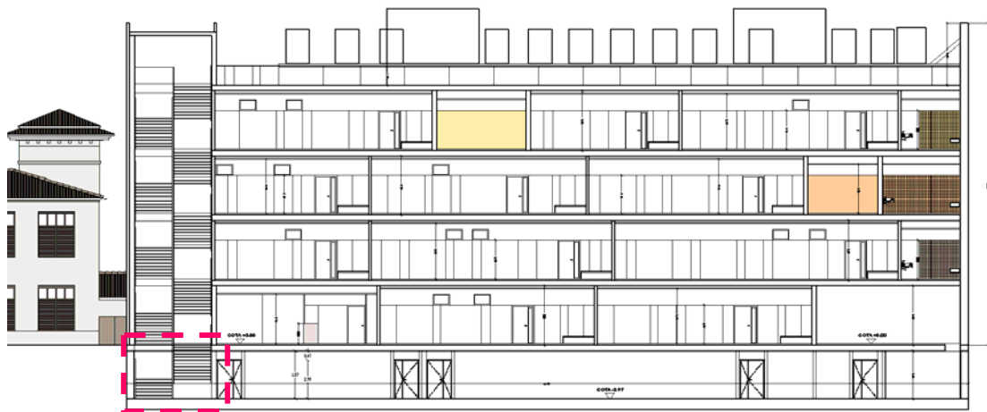
Figura 2. Sección A del edificio, donde se señala el nuevo tramo de escalera a proyectar.
