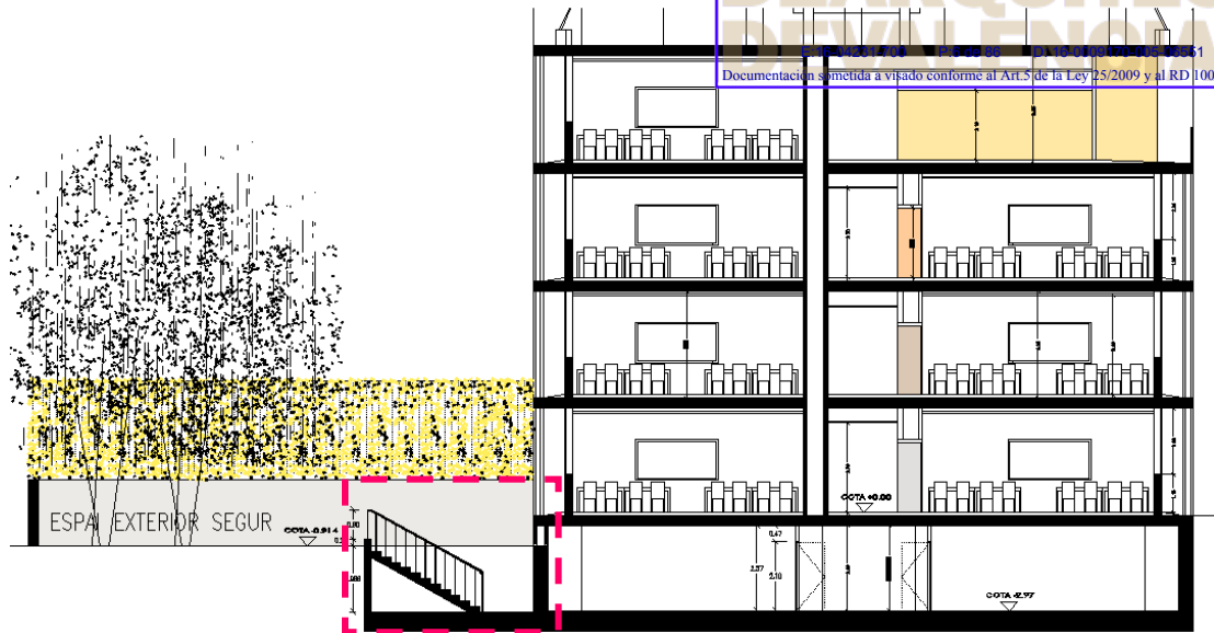
Figura 3. Sección B del edificio, donde se señala la ubicación del nuevo el patio inglés.
