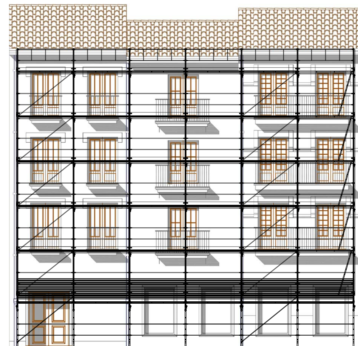
ALZADO FRONTAL ANDAMIO TIPO (a instalar en C/ Bolsería)
