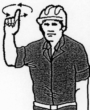
3 Levantar la carga lentamente.
