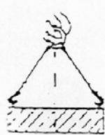
CARGA CON DOS ESLINGAS SIN FIN
