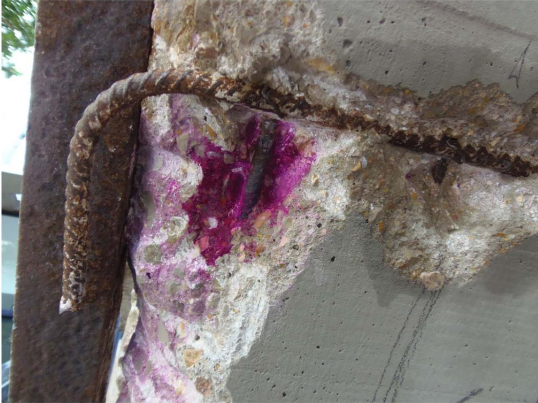
Realización de ensayo de carbonatación
