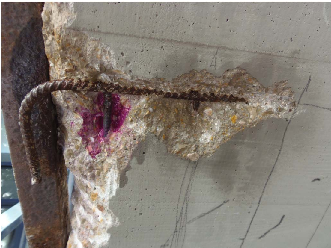
Realización de ensayo de carbonatación
