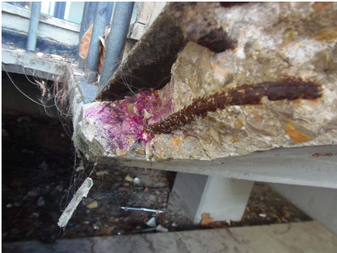
Realización de ensayo de carbonatación
