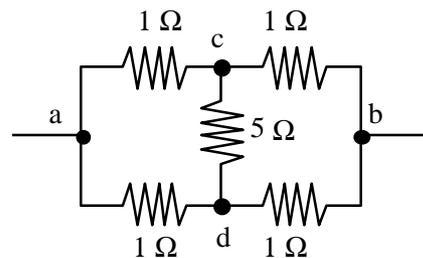
**130.-** Calcular las corrientes  $I_1$ ,  $I_2$  e  $I_3$  en el circuito de la figura, así como la diferencia de potencial entre  $b$  y  $c$ .
