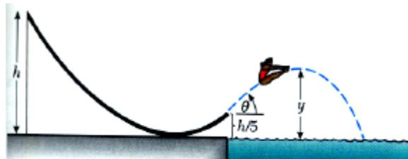
37.- Un carrito de montaña rusa se suelta desde una altura  $h_0$  sobre la parte inferior de una vía sobre la que desliza sin rozamiento.
