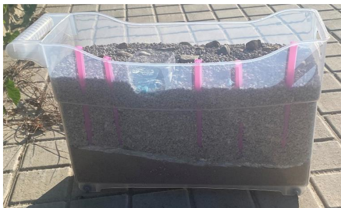
FIGURA 8. Fotografía de un modelo hidrológico sobre un acuífero hecho por un grupo del alumnado de bachillerato. Fuente: Elaboración propia.
