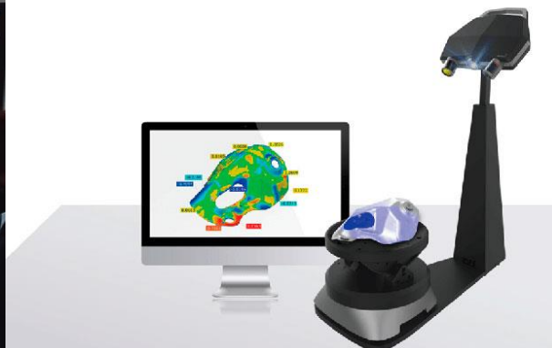
Figura 8. Esquema de un escáner de luz estructurada blanca
