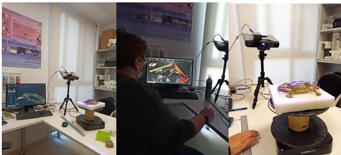
Figura 12. Escáner de luz estructurada blanca del MUVNH escaneando un Cangrejo azul
