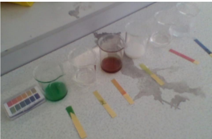
Imagen 3. Medición de pH de diferentes químicos con cintas reactivas
