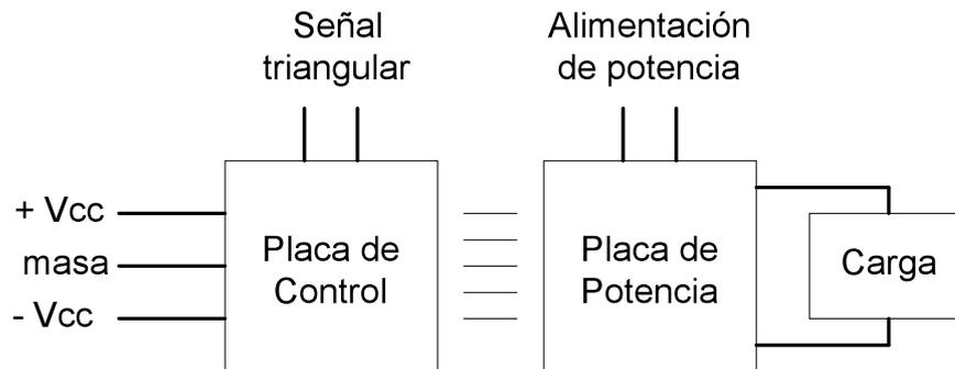
Con la finalidad de implementar en una única placa las distintas técnicas de modulación PWM vistas en el apartado anterior, se han añadido unos interruptores (jumpers) que permiten cambiar la configuración del circuito de control. En la TABLA I se especifica la posición de cada uno de estos jumpers para las distintas técnicas de modulación a implementar.
