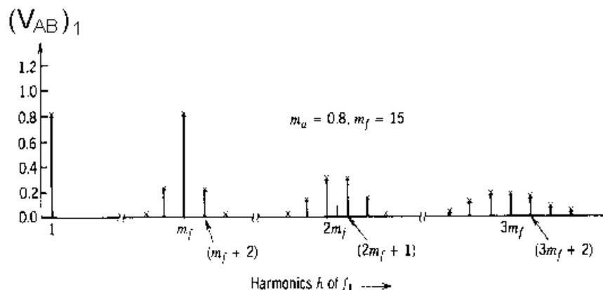
*Espectro de salida para la modulación senoidal del ancho de pulso con flancos de conmutación coincidentes.*
