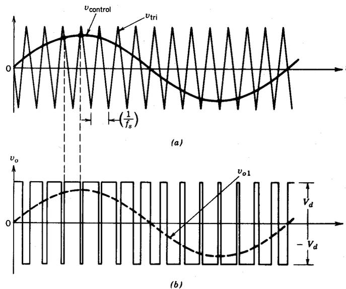
Perfil de tensión para una modulación senoidal del ancho de pulso con flancos de conmutación coincidentes
