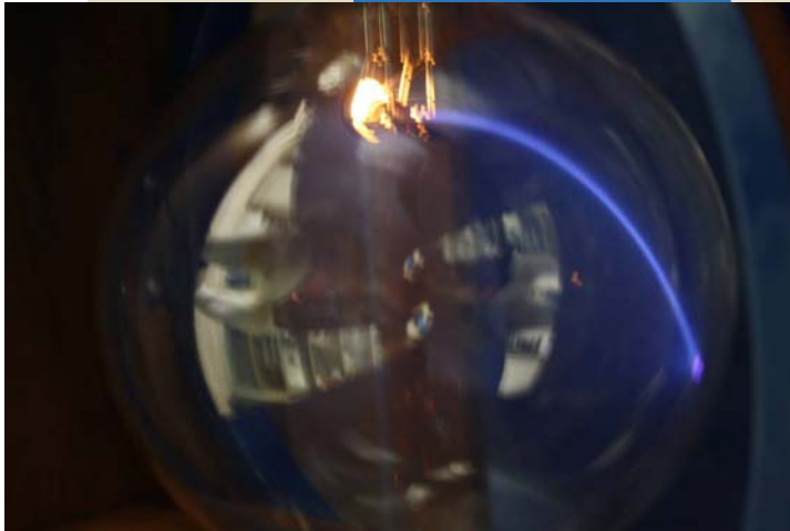
Figura 7: Deflació del haz por el campo magnético.
