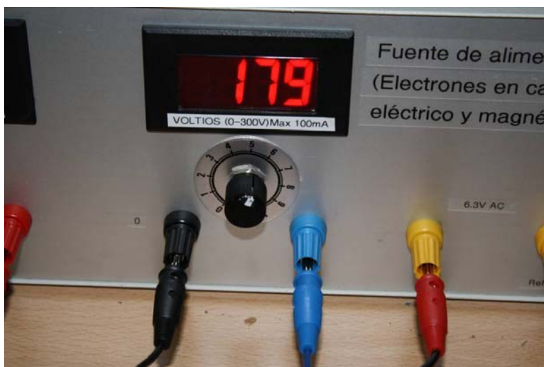
Figura 4: Detalle del cursor y del lector de tensión ánodo-cátodo.
