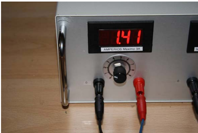
Figura 6: Detalle del cursor y del lector de corriente de las bobinas.
