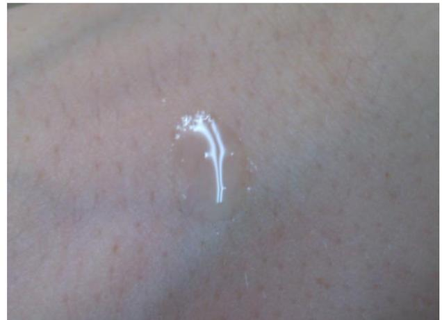
Fig. 1a. Piel con recubrimiento hidrófóbico
