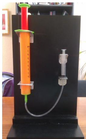
Fig. 2. Montaje para jeringas de distinto tamaño
