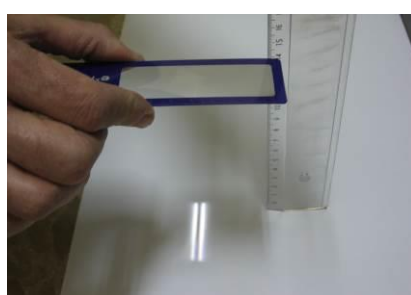
Figura 1: Imágenes reales producidas por la lente de dos objetos lejanos (tubos de iluminación del aula y el Sol). En ambos casos, midiendo la distancia entre la lente y el papel sobre el que se forma la imagen, se puede estimar el valor de la distancia focal de la lente.
