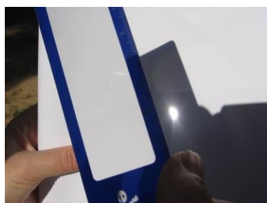
Figura 1: Imágenes reales producidas por la lente de dos objetos lejanos (tubos de iluminación del aula y el Sol). En ambos casos, midiendo la distancia entre la lente y el papel sobre el que se forma la imagen, se puede estimar el valor de la distancia focal de la lente.
