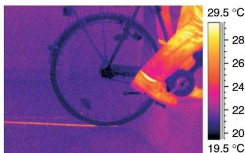
Figura 2. Aumento de temperatura producido por el rozamiento entre el suelo y una rueda de bicicleta.
