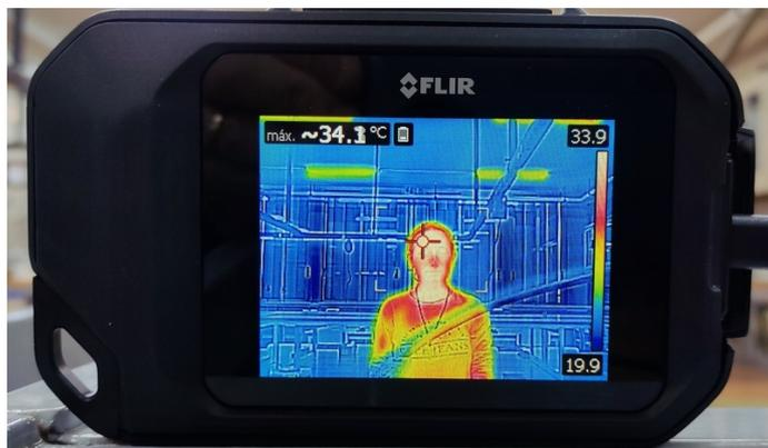
Termografía de una persona en el laboratorio de Física. Se pueden observar diferencias de temperatura entre las distintas partes del cuerpo (por ejemplo, menor temperatura en la nariz), o identificar los tubos de luz a mayor temperatura.
