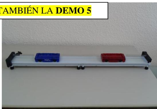
Fig 1. Carril inclinado y móvil con muelles en los dos extremos Fig. 2 Carril y móviles acoplados con los tres muelles.
