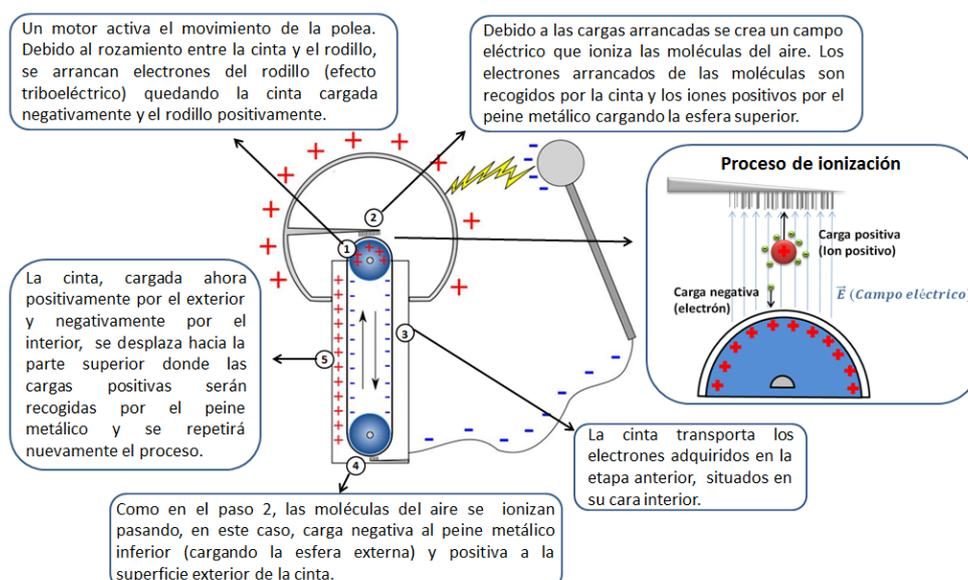
El generador de Van de Graaff es un instrumento que utiliza una cinta móvil para acumular grandes cantidades de carga eléctrica en el interior de una esfera metálica hueca. Las cargas se obtienen mediante el rozamiento de la cinta con otro cuerpo (efecto triboeléctrico).
