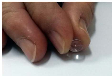
Figura 4. Una manera de estimar la distancia focal de la gota de silicona.
