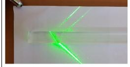
El haz que se introduce por una cara en la barra de metacrilato llegará al otro extremo de la barra y volverá a refractarse hacia el exterior y reflejarse hacia el interior. Al salir la luz hacia fuera no hay un efecto de guiado dentro de la barra de metacrilato.
