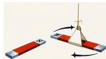
**Demostración 3 – Orientación de un imán que pende de un hilo. LA BRÚJULA**
