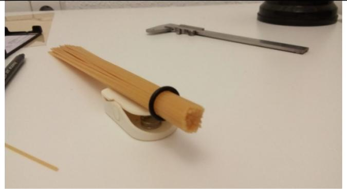
Disponemos de un anillo de sección transversal  $A$  conocida (midiendo el diámetro). Podemos determinar la densidad de corriente volumétrica  $J$  contando el número  $N$  de varillas que caben en esa sección y dividiendo por el valor de la sección transversal:  $J = N \text{ varillas(mA)} / A \text{ (cm}^2\text{)}$ .
