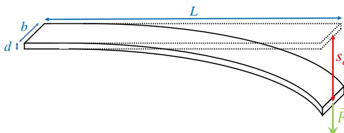
Figura *b*. Flexión de varilla sujeta por un extremo tras aplicar una fuerza verticalmente por el otro extremo.
