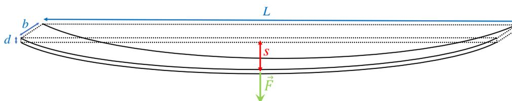
Figura *a*. Flexión de varilla sujeta por los dos extremos tras aplicar una fuerza hacia abajo verticalmente en su centro.
