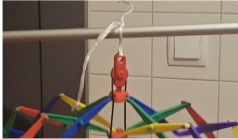
Procurar que el hilo del mecanismo interior que contrae la rueda pase sin torcerse por el interior de la garganta de la polea del mecanismo de contracción
