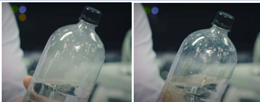
Figura 1. Al expandirse la botella (imagen izquierda), el vapor de agua se expande y se enfría, provocando la condensación. Cuando se comprime la botella (derecha) el vapor de agua aumenta su presión y su temperatura y no se produce condensación.
