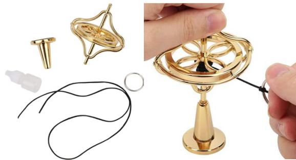
Figura 1. Izquierda: material de la práctica. Derecha: ejemplo de puesta en marcha del giróscopo.
