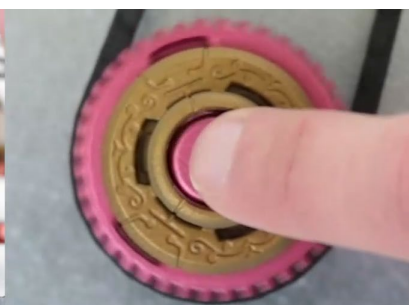
Interruptor: abre y cierra los circuitos
