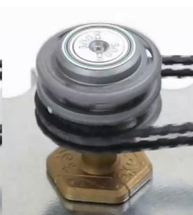
Resistencias. Mayores o menores según la velocidad (menor o mayor respectivamente) de giro
