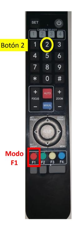
MODO F1 (Botón ROJO): La cámara tiene tres posiciones fijas que se pueden ir modificando en función de cómo se de la clase.
