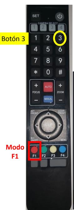
MODO F1 (Botón ROJO): La cámara tiene tres posiciones fijas que se pueden ir modificando en función de cómo se de la clase.
